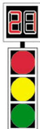
Semafor combinat cu dispozitiv de cronometrare a timpului aferent culorii
